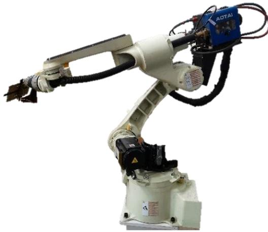
图 2-1 焊接机器人实机图
