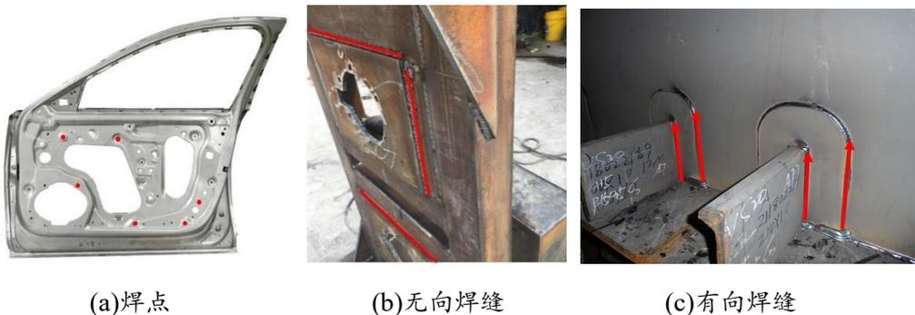
图 4-7 焊点和焊缝作业图
