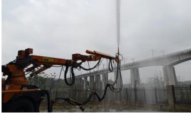
图 6-8 带负载喷水实验示意图
