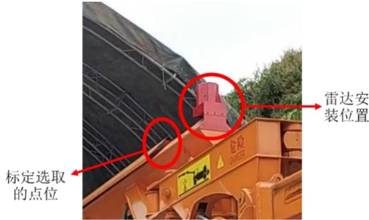
图 3-4 扫描装置安装实物图
