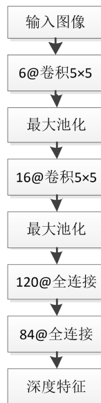
图 4-3 基于 LeNet 模型的深度特征提取过程
