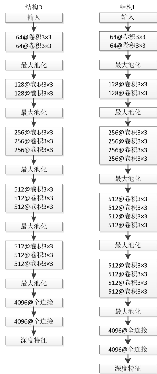
图 4-5 基于 VGG 结构 D 和结构 E 提取场景图像深度特征
