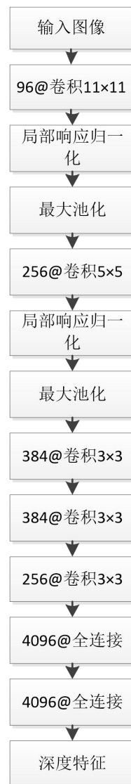
图 4-4 基于 AlexNet 模型的深度特征提取过程
