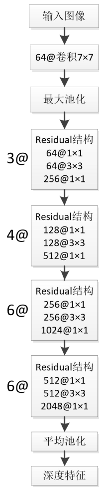
图 4-10 基于 ReNet 模型的深度特征提取过程
